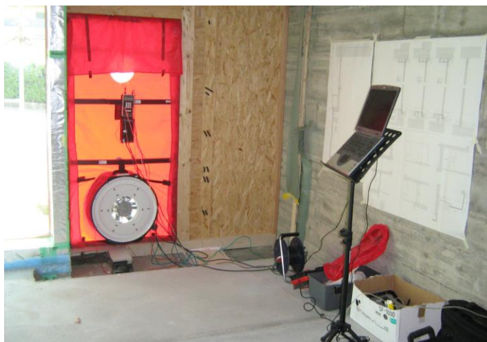
Esecuzione test Blower door
